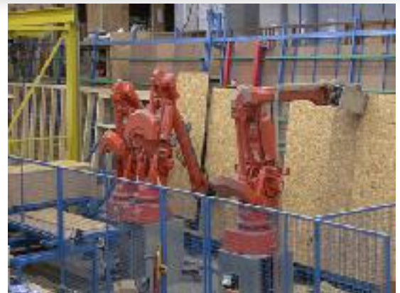
Ligne de production de murs
